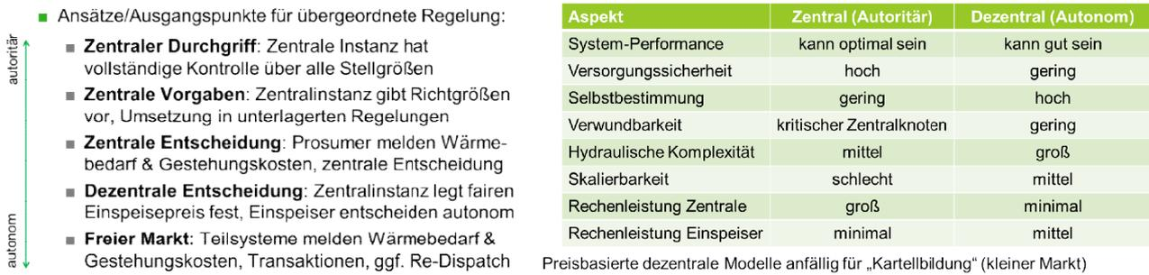
**Abbildung 8: Ansätze für die übergeordnete Regelung im Spannungsfeld zwischen zentral und autonom organisierten Zugängen mit einer Auflistung einiger Stärken und Schwächen des jeweiligen Zugangs.**
