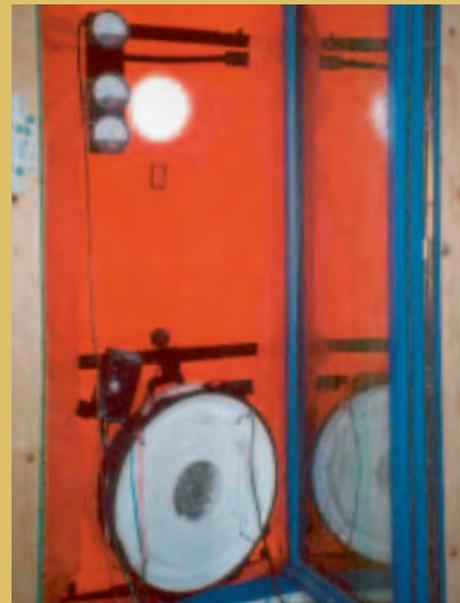
*$n_{50}$ -Drucktest mit einem Blower Door Gerät: Für den Test wird die Blower Door mittels einer Membran in eine Öffnung (Tür, Fenster) des Hauses eingesetzt und luftdicht verklebt.*
