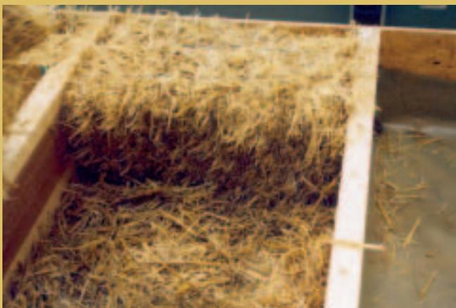
Vorfertigung einer Holzständerkonstruktion mit Strohdämmung im Werk. Bei korrektem Einbau ist Stroh eine preisgünstige Alternative zu herkömmlichen Dämmstoffen.
