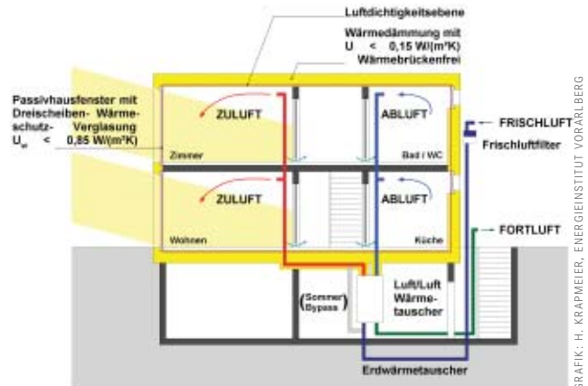
Schemazeichnung des Passivhaus-Haustechnik-konzeptes
