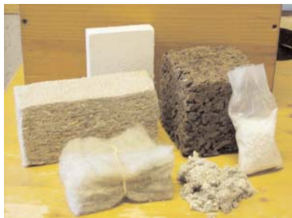
Verschiedene Dämmstoffe: Calciumsilikat, Hanfplatte, Schafwolle, Zellulose, Perlite, Kork
