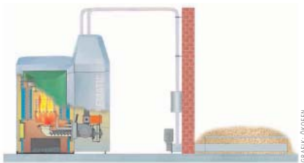
Pelletsanlage mit Vakuuman-saugung des Brennstoffes aus dem Lagerraum
