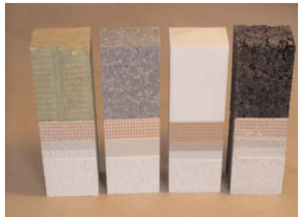
Modelle eines Wärmedämmverbundsystems mit Mineralfaser, grauem Polystyrol, weißem Polystyrol, Kork (von links nach rechts)
