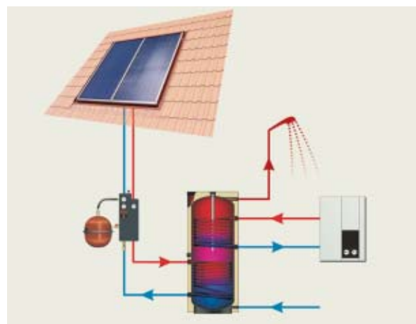
Schema einer Solaranlage zur Warmwasserbereitung mit Schnitt durch den Speicher
