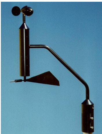
Abb.2: Links: Kombiniertes Windsensor Type 263 (Quelle: www.kroneis.at )
