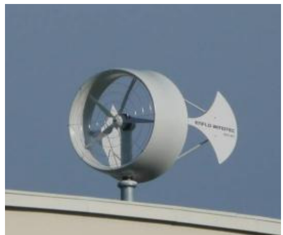
Abbildung 11: Eingehauste Bauform mit speziellem Windleitsystem
